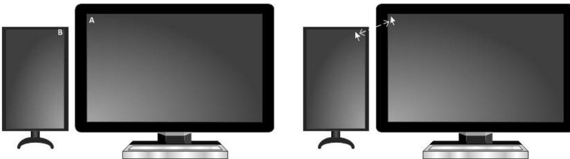
Abbildung 5–15 Bewegung von Punkt A nach links und von Punkt B nach rechts mit *SmartCursor*.
